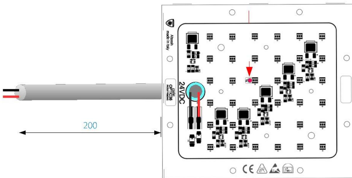
E' necessario rimuovere l'ottica secondaria per posizionare la sonda di rilievo Tc successivamente riposizionare l'ottica avendo cura di reinserire la guarnizione in silicone..
